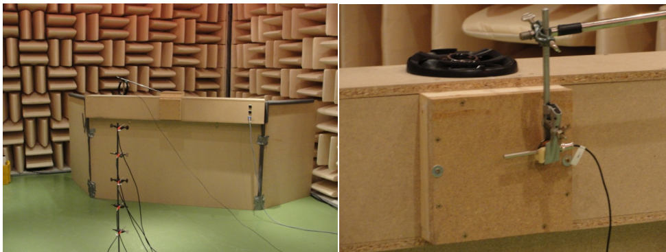
Abbildung 8: Modellschallschutzwand mit ANC-Aufsatz im akustischen Halbfreieldraum der SLG.
