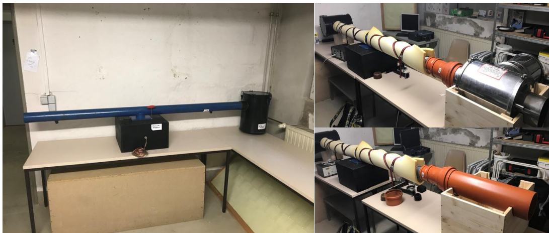
Abbildung 4 Schalldämpferprüfstand vor Instandsetzung (links) und danach (rechts)
