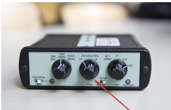
Abb.8 Akku für das Messmikrofon mit Filter
