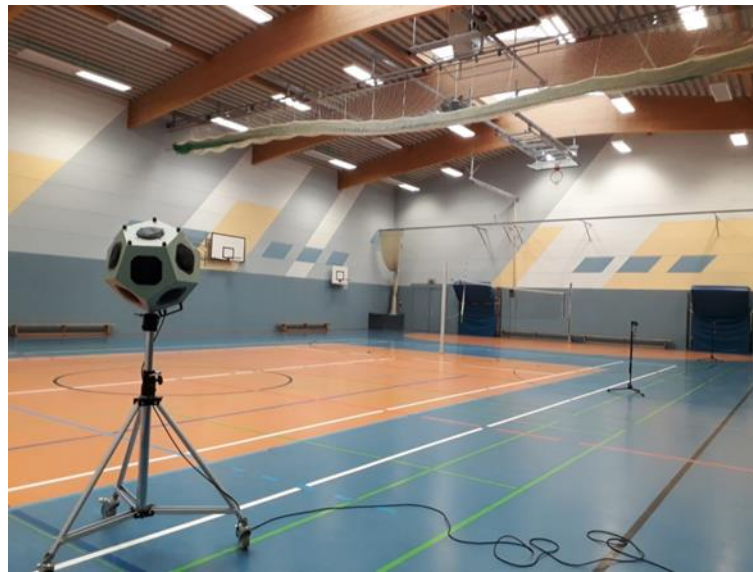
Abbildung 15: Messaufbau in der Mehrzweckhalle, SP1, MP1 & MP2
