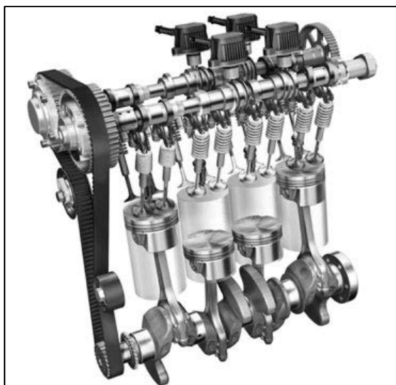
Abbildung 1 Aufbau Viertaktvierzylinderottoverbrennungsmotor [Teichmann/Merker 2019]
