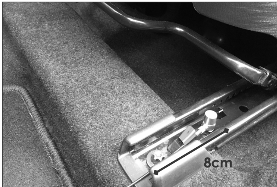
Abbildung 17 PCB352C33 Beschleunigungssensor auf der Beifahrersitzschiene des BMW Mini
