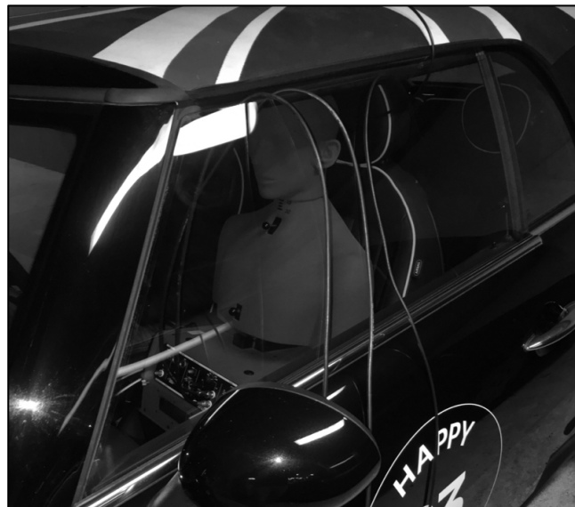
Abbildung 16 Kunstkopfmikrofonie im Fahrzeug
