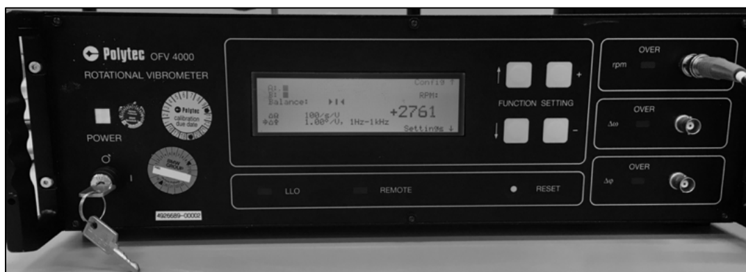
Abbildung 11 Verarbeitungseinheit Polytec OFV 4000 mit einer ermittelten Drehzahl von 2761 \text{ min}^{-1}
