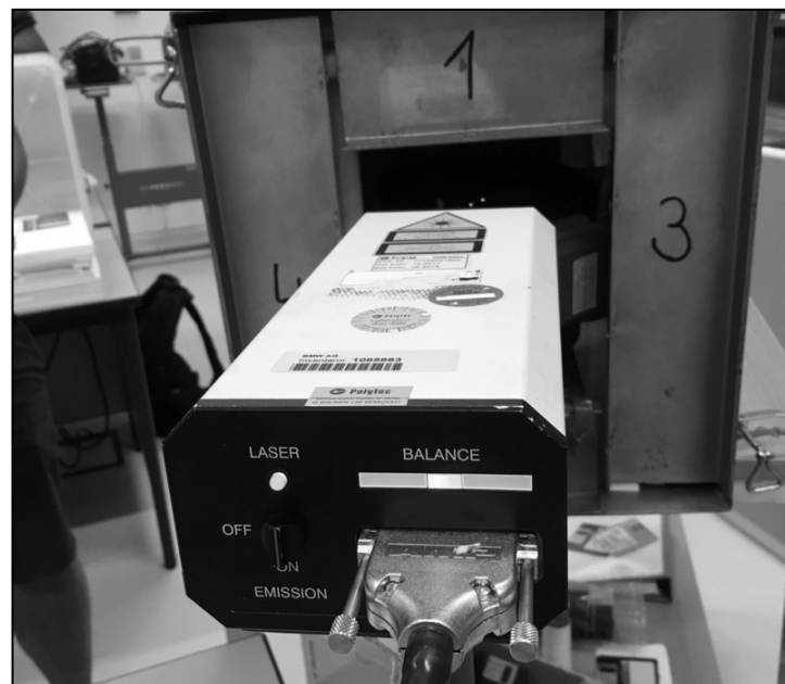
Abbildung 12 Sensorkopf OFV 400 korrekt ausgerichtet mit grüner LED in der Mitte der Balanceanzeige
