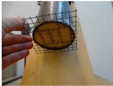
Abbildung 10: Einbringung einer Stoffprobe in das untere Rohrende.
