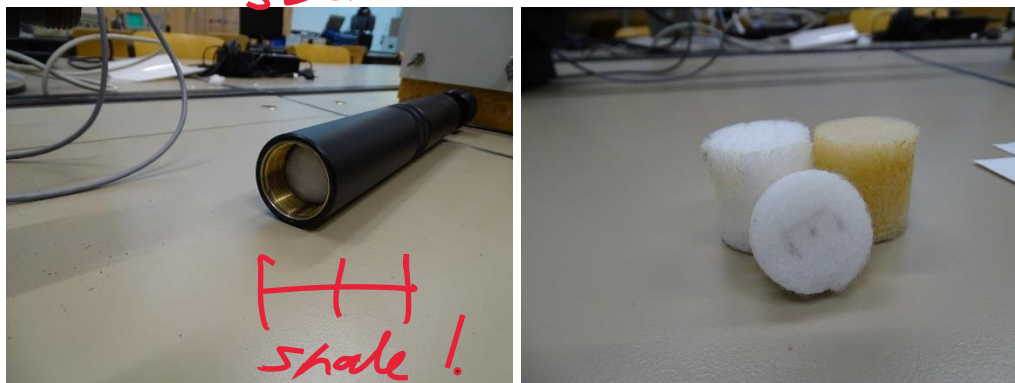
Abbildung 6: Probenhalter mit 3 cm Durchmesser (links) und zugeschnittene Probe (rechts).
