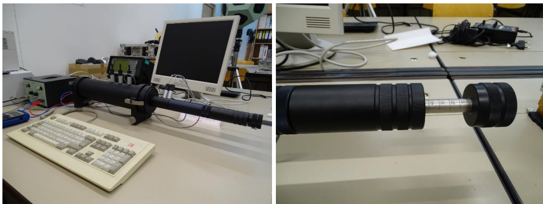
Abbildung 7: Versuchsaufbau Kundt'sches Rohr.
