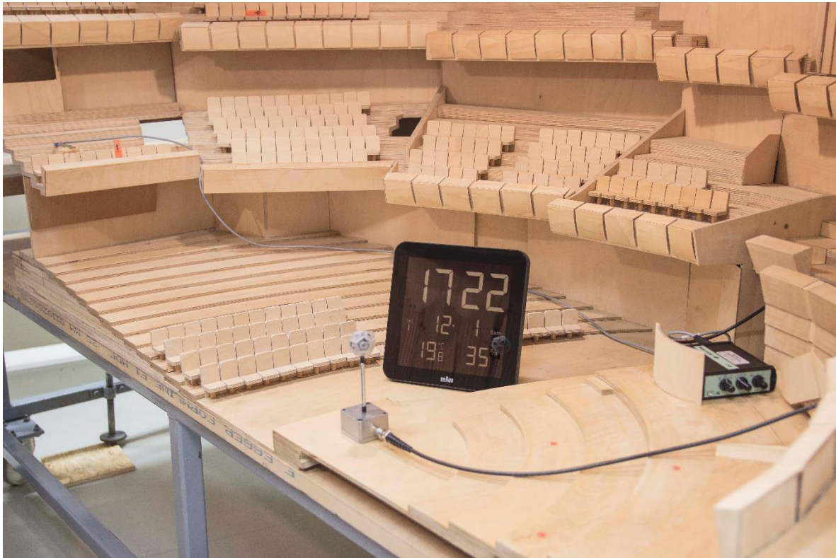
Abbildung 15 Messung der Temperatur und Luftfeuchte zwischen den Messungen mit dem Modell geöffnet
